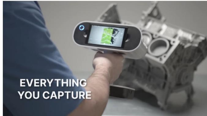
*Nota.* Verificación de escaneo en la pantalla del equipo. Tomada de Artec 3D [Captura], Ready. Set. Scan. – With Artec Leo, it's that easy, 2022, <http://www.artec3d.com>.
