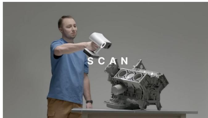
*Nota.* Escaneo de todas las partes del equipo automotor o industrial para obtener el archivo en 3D. Tomada de Artec 3D [Captura], Ready. Set. Scan. – With Artec Leo, it's that easy, 2022, <http://www.artec3d.com> [3][4].
